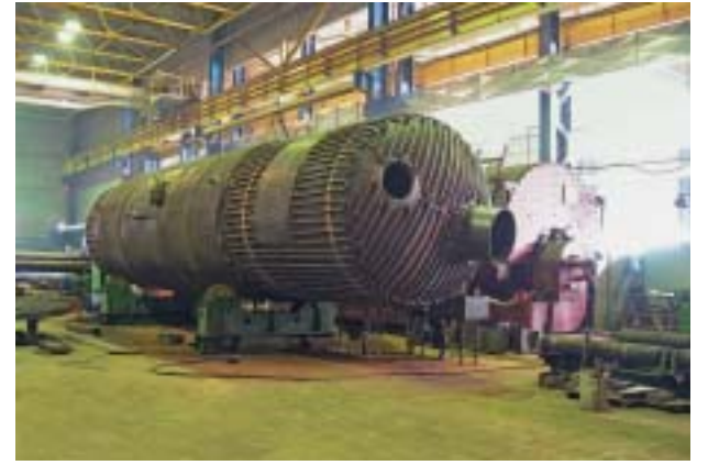
В производстве запасных частей и малых котельных установок ЗАО «Котельный завод «Белэнерго-маш» - барабан котла-утилизатора Г - 420 БПЭ, предназначенного для получения перегретого пара за счет использования тепла нитрозных газов в схеме получения слабой азотной кислоты.
