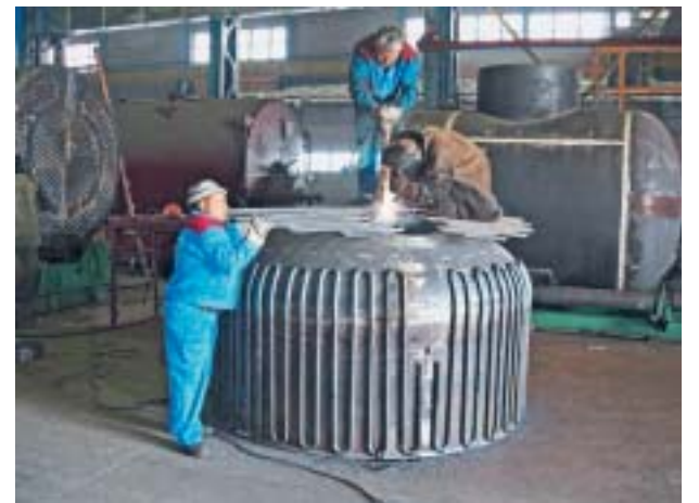
Котельщики Василий Иванович Балдин, Юрий Николаевич Кобыков и сварщик Юрий Владимирович Панов за монтажом змеевиков на поворотной камере, предназначенных для разогрева камеры во избежание конденсации из нитрозных газов азотной кислоты во время пуска и останова котла.
