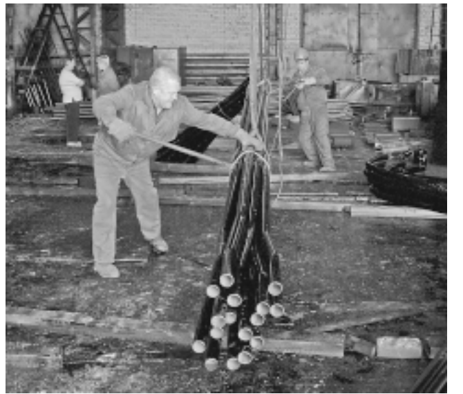
Слесарь-сборщик металлоконструкций Анатолий Федорович Шевцов и котельщик Павел Иванович Роганский выполняют упаковку труб котла ГМ-50-1 перед отправкой заказчику. До этой завершающей операции прокат прошел зачистку, резку, гибку, стыковку и контроль швов.
