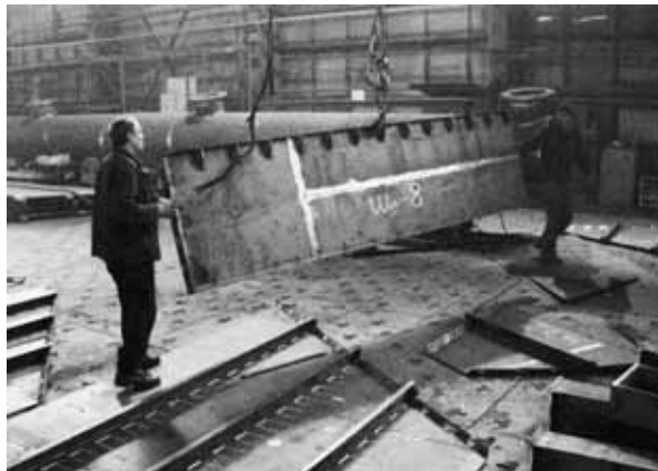
Слесарь-сборщик Виктор Селюков и сварщик Александр Селин перемещают при помощи грузоподъемных механизмов щиты - детали металлоконструкций для завода железобетонных конструкций.
